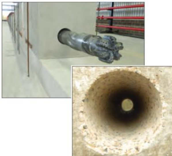
Рисунок 3. Плавное прохождение через тестовые блоки. Лазерные штангенциркули не выявили шероховатости в скважине, пробуренной PowerDrive Archer RSS.
