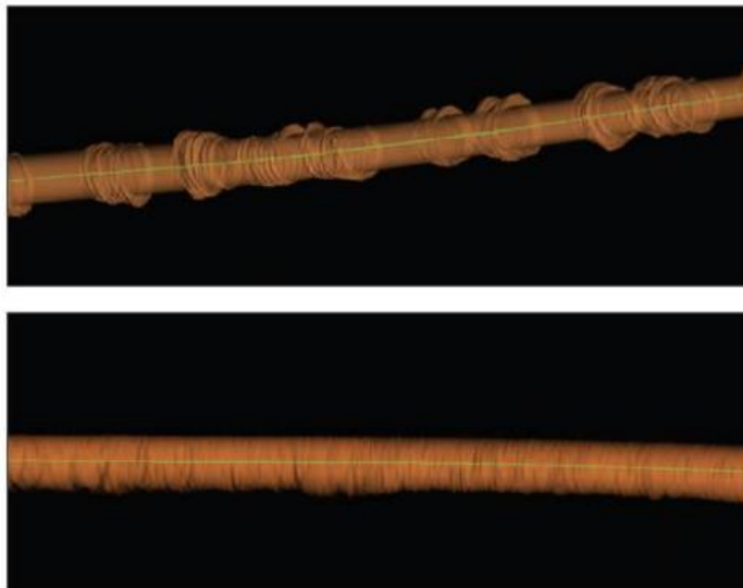
Рисунок 4. Сравнение качества ствола скважины, построенного по данным каверномера: сверху – забойный двигатель с кривым переводником, снизу – роторная управляемая система
