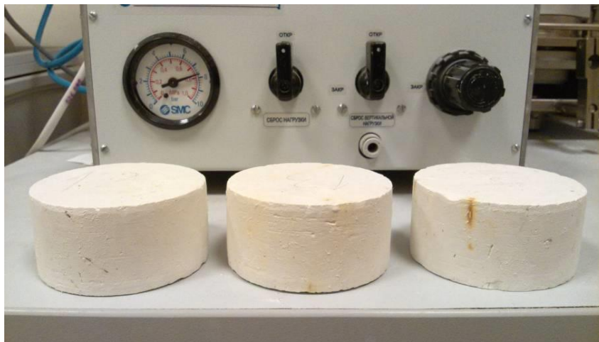
Рисунок 1. Образцы мела для испытаний методом одноплоскостного среза
