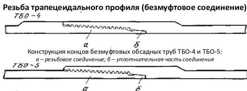
Рисунок 2. Безмуфтовое соединение
