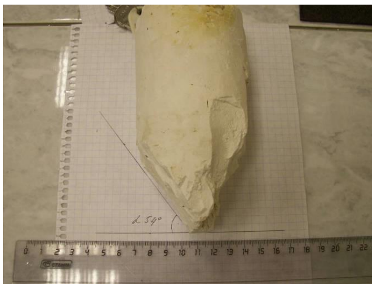
Рисунок 3. Измерения угла наклона площадок сдвига на образцах мела после испытаний
