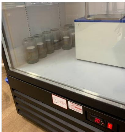
Рисунок 4. Хранение контейнеров в холодильнике при t=20^{\circ} .
